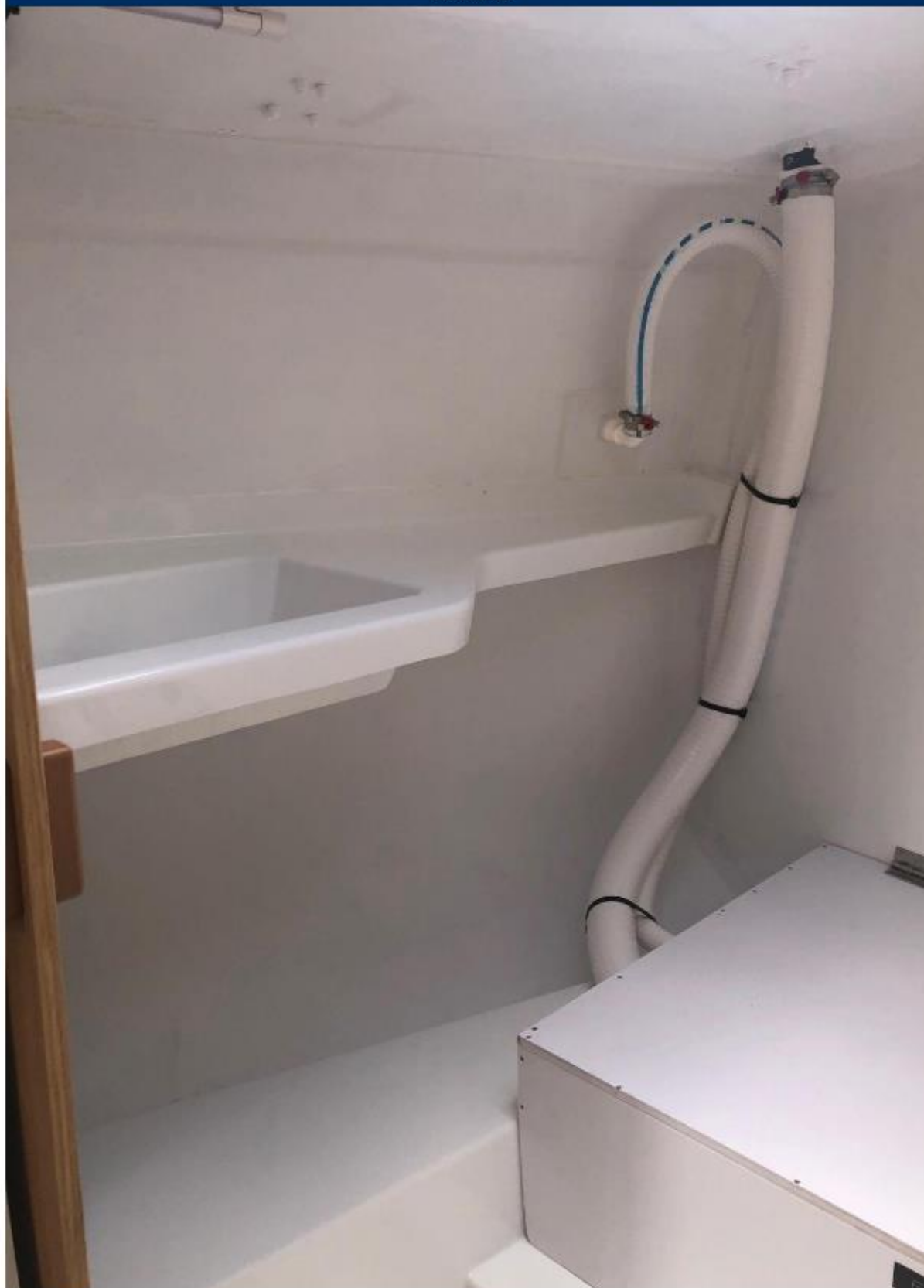
A BÂBORD : MEUBLE MOULÉ EN POLYESTER ET VASQUE LÉGÈRE COMPOSITE AVEC ROBINET EAU SOUS PRESSION
