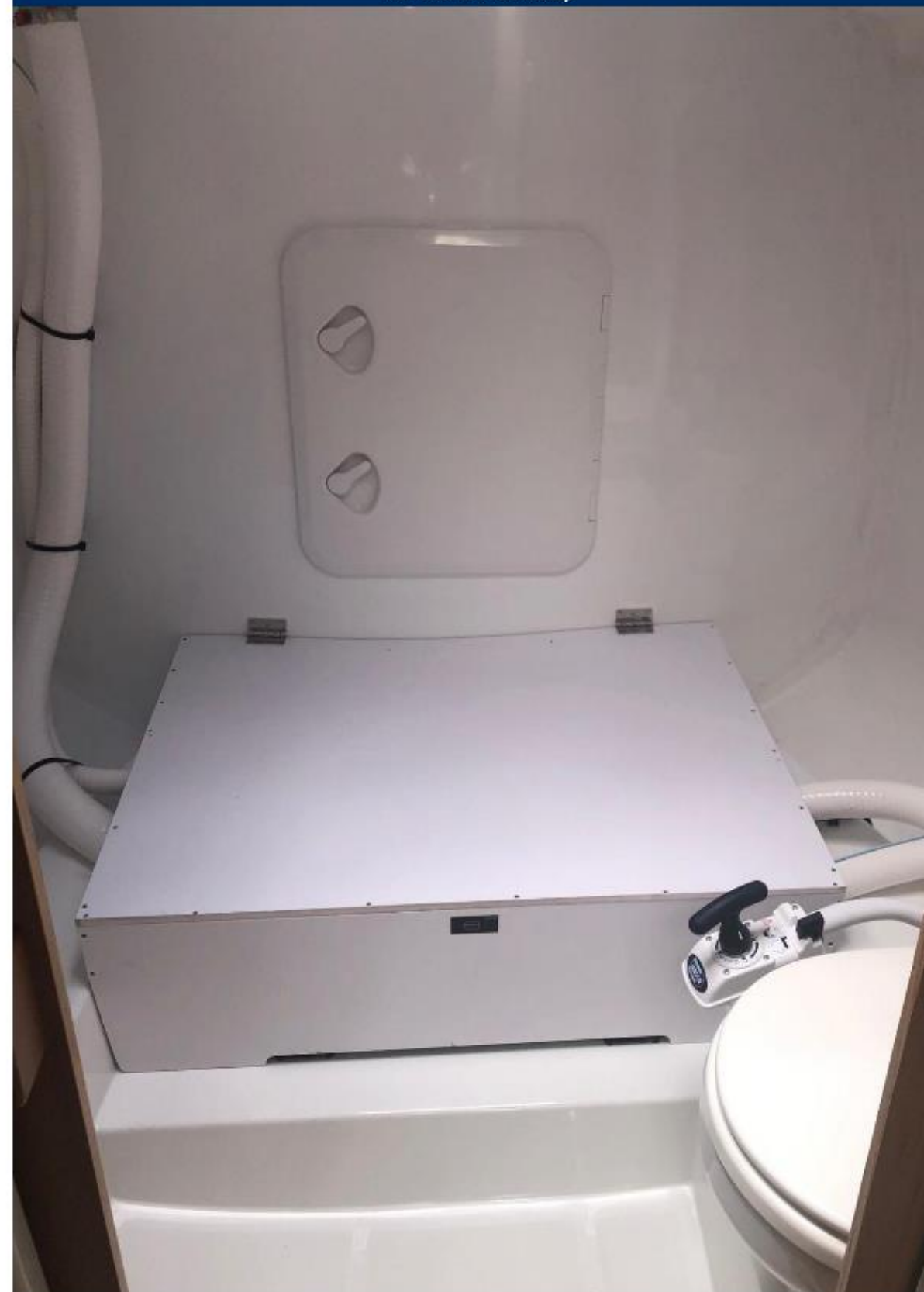
AU CENTRE : RÉSERVOIR D'EAUX NOIRES 80 L / 21 US GAL AVEC MACÉRATEUR ET VANNE FLUSH (INCLUT DANS L'OPTION WC MANUEL)
