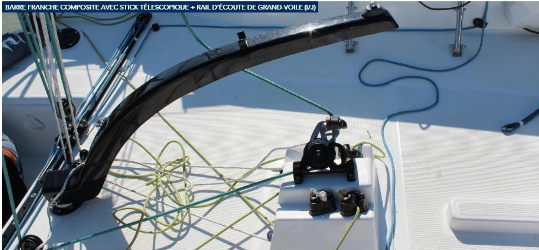
BARRE FRANCHE COMPOSITE AVEC STICK TÉLESCOPIQUE + RAIL D'ÉCOUTE DE GRAND-VOILE (I/J)
